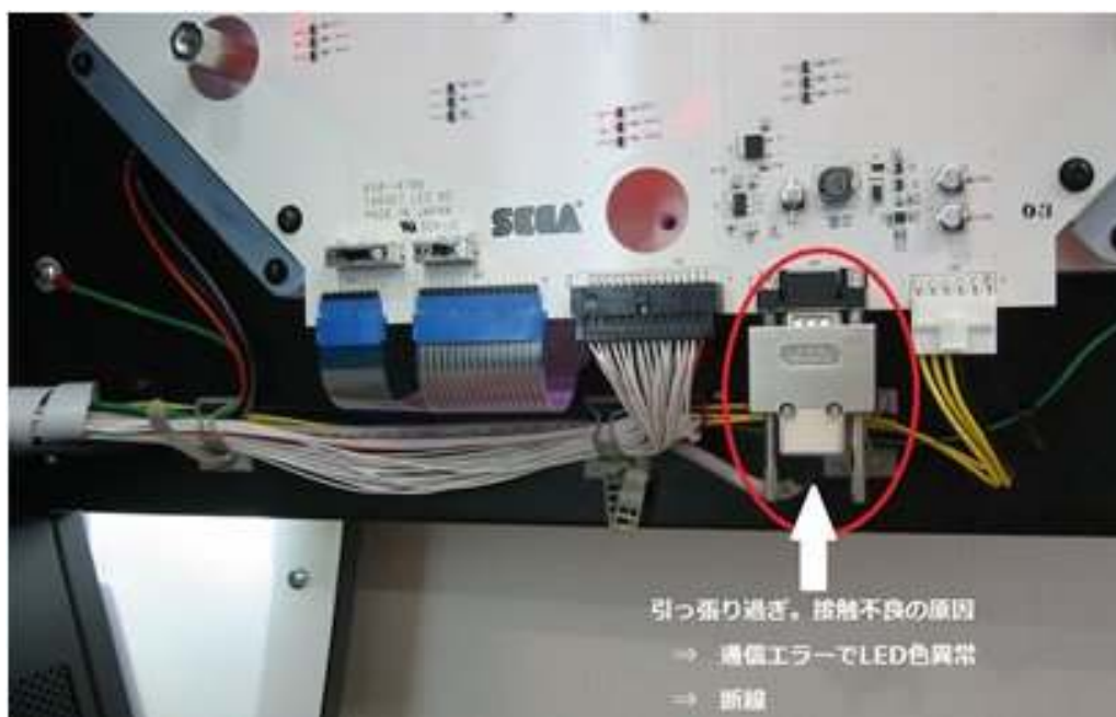
写真 ; コネクタ内部断線例
