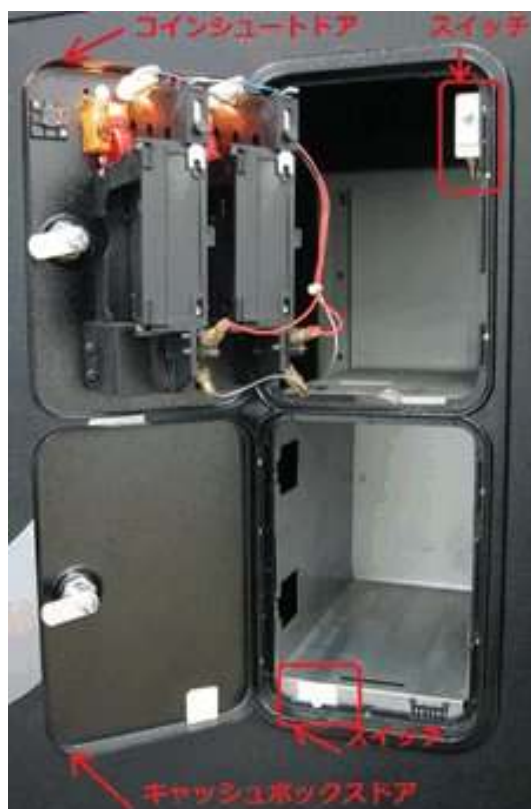
写真 Avanti;コインドア内側にあるスイッチ
