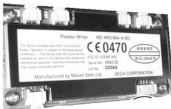
写真; DL2 カードリーダー制御基板
